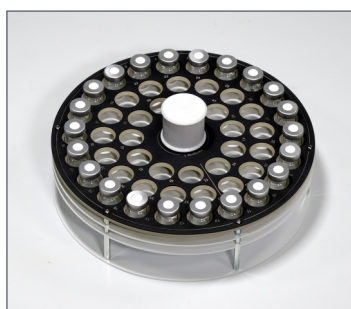
不同规格试瓶:样品架和加热炉可互换使用
