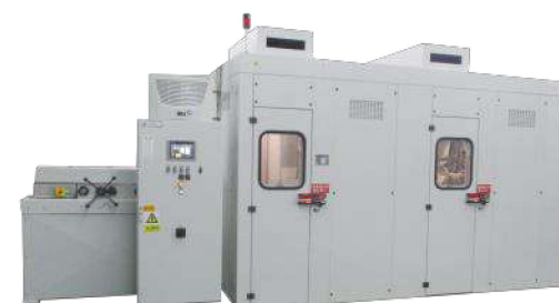
18锭德国进口 Mayer 编织机 (3台) 20锭意大利进口 OMA 编织机 (3台) Mayer 18-carriers braiding machine (3 sets) OMA 20-carriers braiding machine (3 sets)
