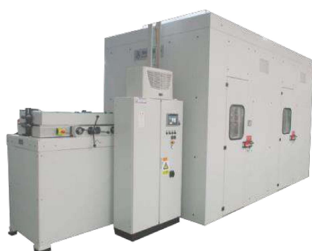
36锭德国进口 Mayer 编织机 (1台) 48锭意大利进口 OMA 编织机 (1台) Mayer 36-carriers braiding machine (1 set) OMA 48-carriers braiding machine (1 set)
