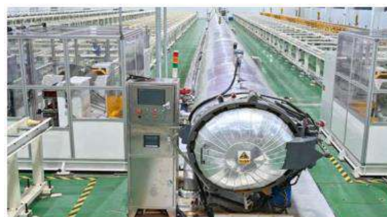
硬芯硫化生产线 (63米硫化缸) Rigid Mandrel Line Autoclave (63m)
