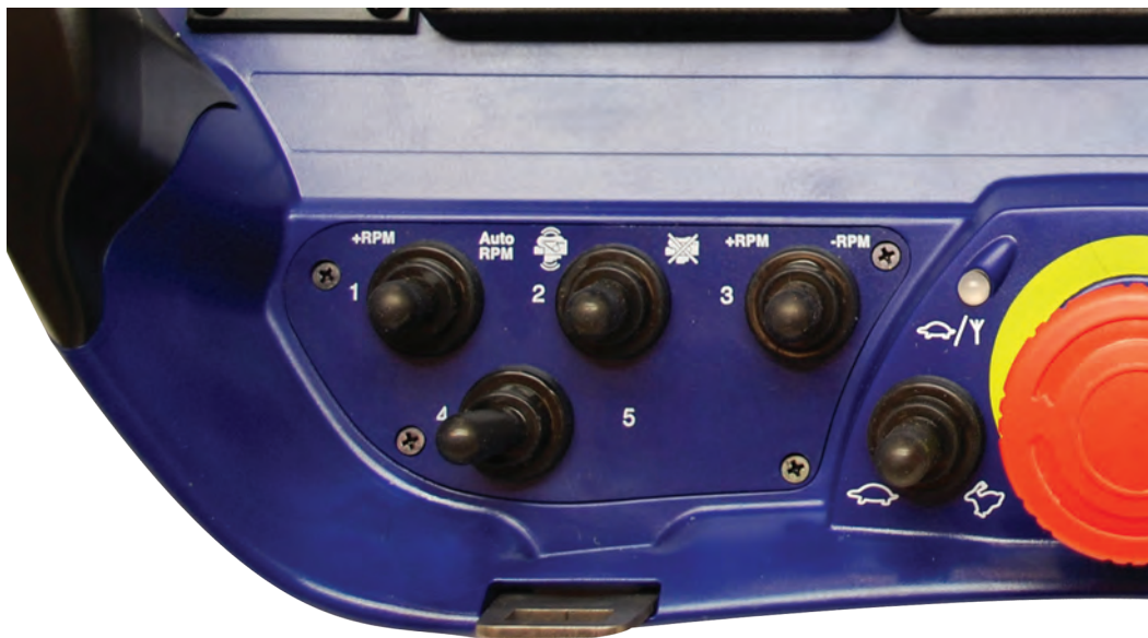
图3.5 MAXI PCU的左开关面板
