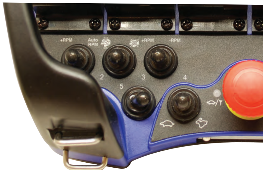
图3.6 MINI PCU的左开关面板
