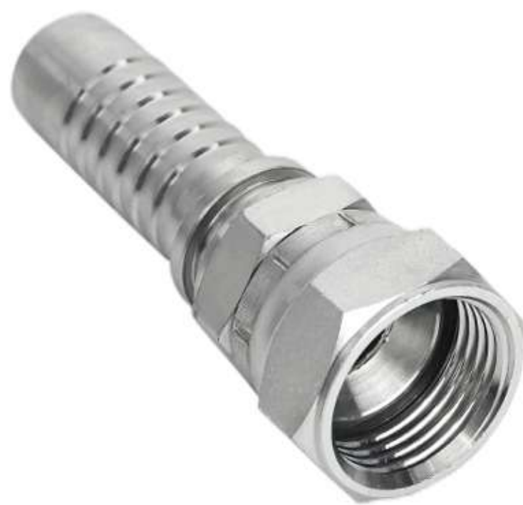
款号 NO. : 26711D ITEM: JIC female 74°double hexagon 美制JIC外螺纹74°内锥面带六角
