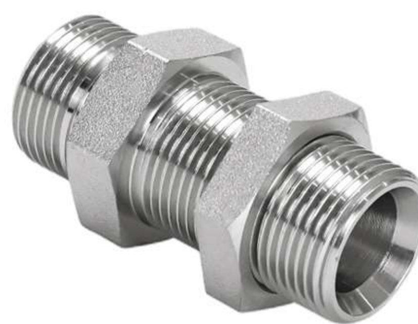
款号 NO. : 6B ITEM: BSP male 60° seat bulkhead 英管外螺纹60°内锥穿板接头
