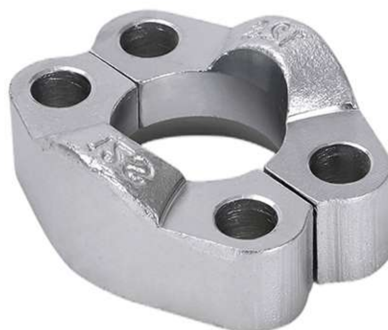
款号 NO. : FL/FS ITEM: Sae split flange clamps 3000psi / 6000psi SAE对开法兰夹3000PSI/6000PSI
