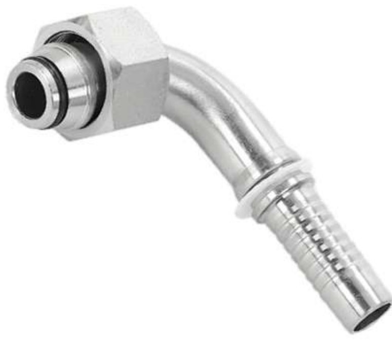
款号 NO. : 20491/20591 ITEM: 90° metric female 24° cone o-ring L.T/H.T 90°公制内螺纹24°锥带O型圈轻/重系列
