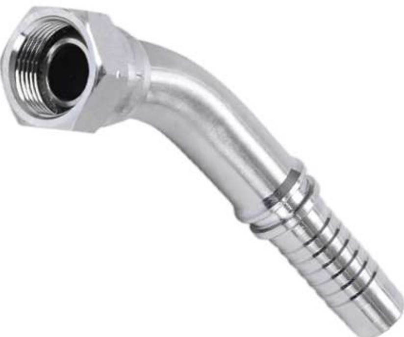
款号 NO. : 22641 ITEM: 45° BSP female 60° cone 45°英管内螺纹60°外锥面
