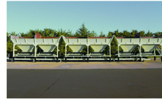
▲ 骨料仓容积加大为11立方, 上料宽度加宽到3.5米, 有效减轻装载机料压力
