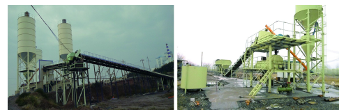
▲ 用于内蒙古赤峰元宝山区古镇第一煤矿的LWBZ500连续式矿用回填设备
