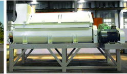
▲ 加长型双卧轴强制制式搅拌机 (国内最长), 沸腾式搅拌, 保证足够的搅拌时间, 大大提高搅拌均匀性
