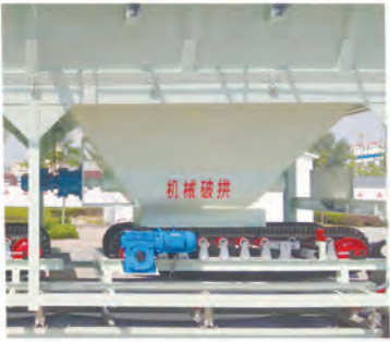
▲ 可选配机械破拱装置，确保石粉类物料的下料顺畅
