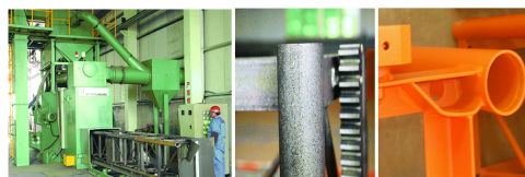
标准节进行整体抛丸处理 Mast section shot blasting
