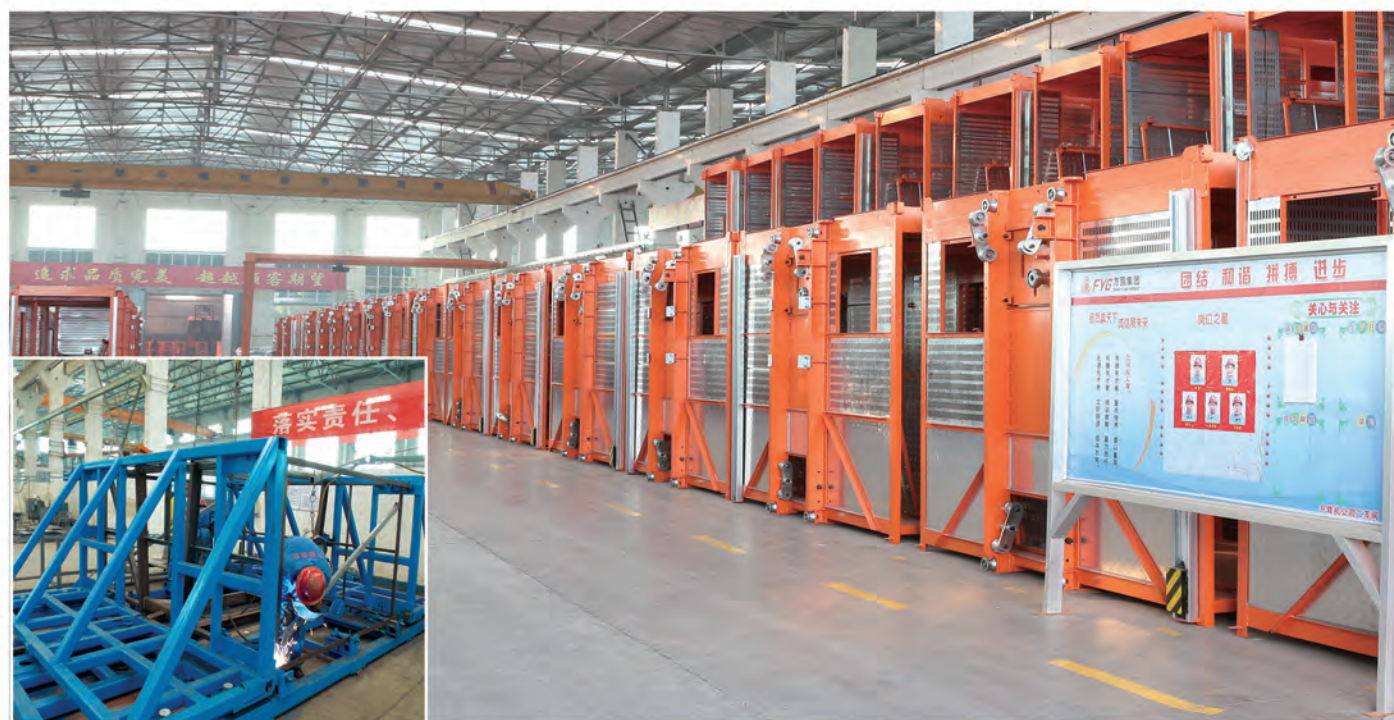
▲ 吊笼整体组焊工装
