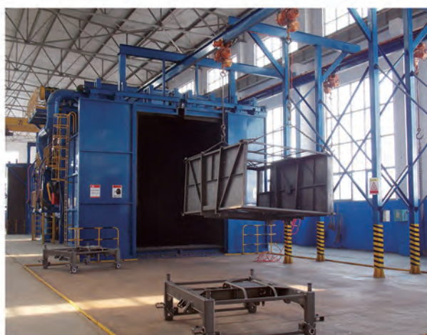
▲ 结构件进行整体抛丸处理
