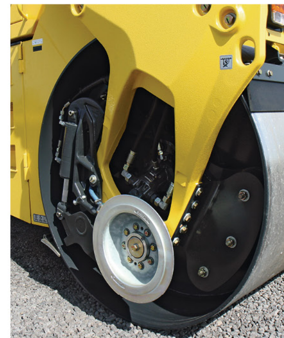
选购件：切边器及压边器，高效的完成压边切边工作
