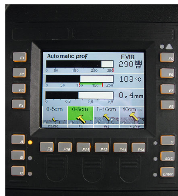
沥青压实专家系统(AM2)的控制面板
