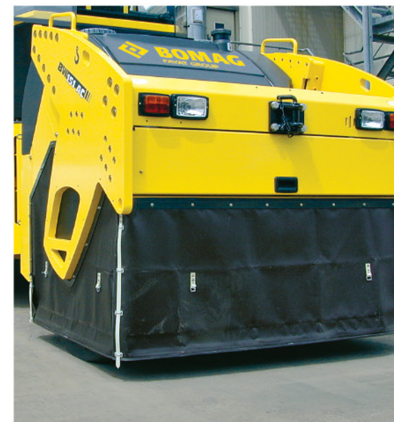
选购件：热裙，用于组合式压路机，保持轮胎温度
