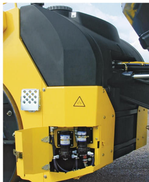
水箱容积大，工作时长。避免频繁的停机加水。两个洒水泵，延长可持续工作时间
