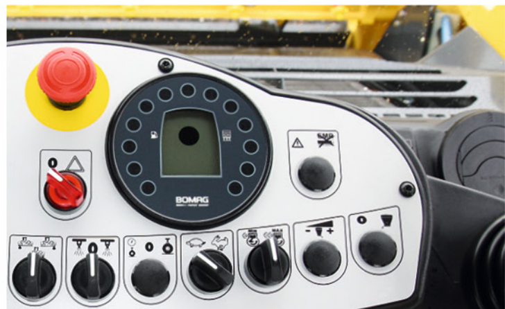
安全性:居中布置的紧急停机按钮和故障报警灯
