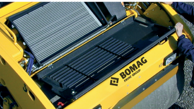
散热器易于接触,清洗方便
