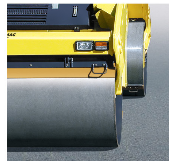
标配的170毫米蟹行错位系统(SL机型除外)
