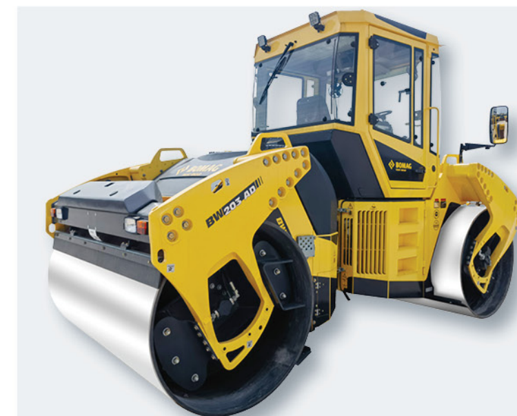
操作人员的安全性得到最大保障:配护栏和ROPS/FOPS保护
