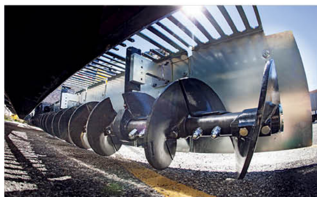
由耐磨铸铁制成的叶片直径400毫米
