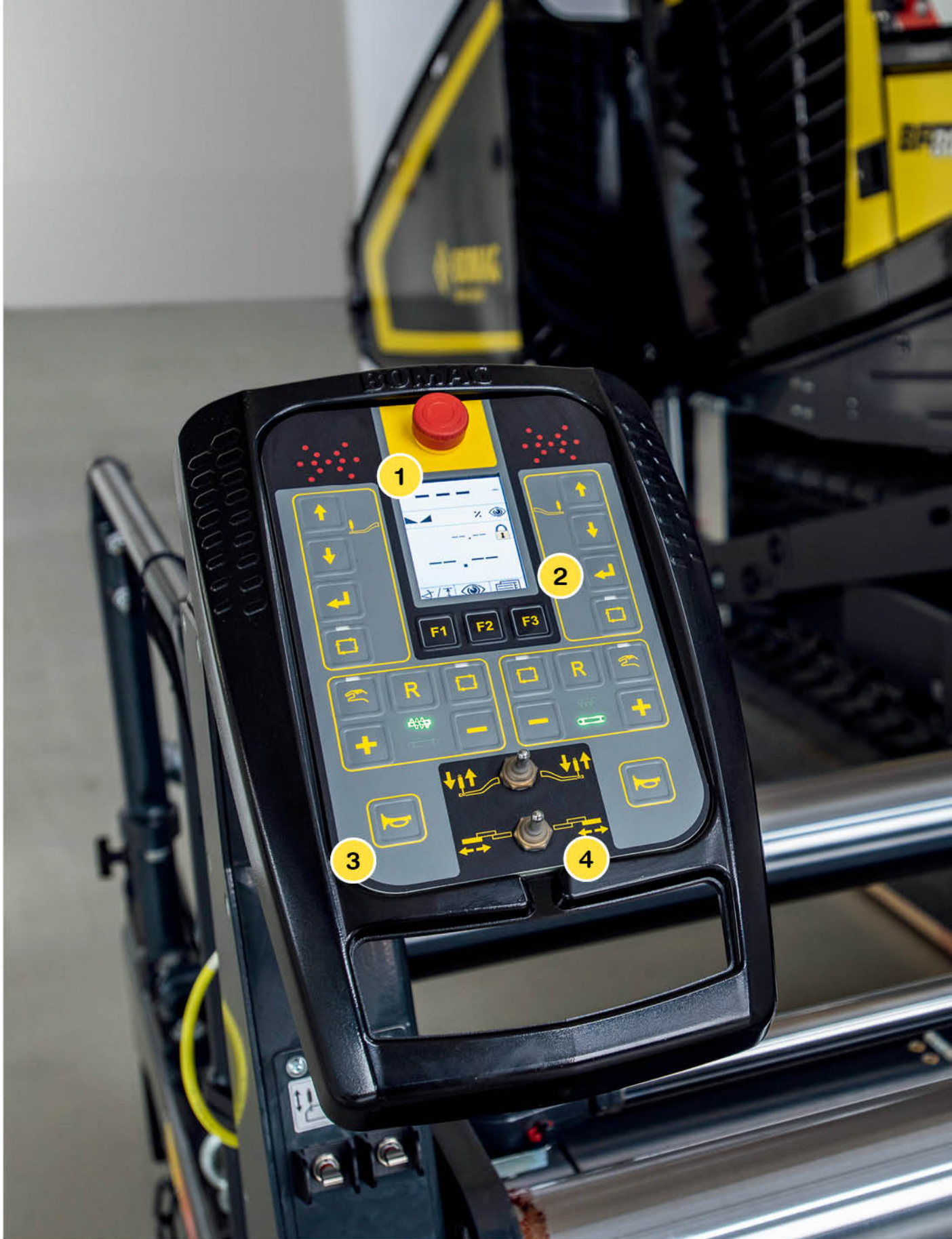
侧面安装的控制面板提供了准确的信息，对于摊铺路面来说是至关重要的。
