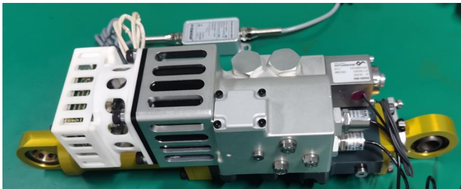
EHA—总重 5kg, 输出 9KN, 3KW
