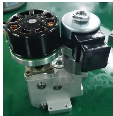
微型浮力调节系统, 0.1L/min, 布置直径 120mm
