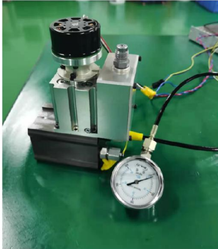
微型顶推系统 200x200x80, 出力50KN
