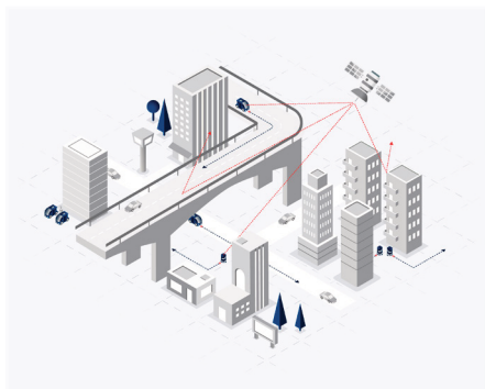
GNSS信号在桥下及 高楼旁受到遮挡
