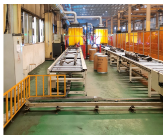
门架焊接生产线
