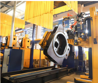
上下支座焊接
