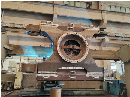
中心支架焊接
