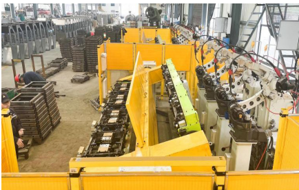
升降机框架焊接
