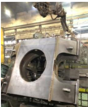
中心支架焊接应用
