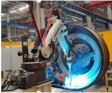
动力头箱体焊接
