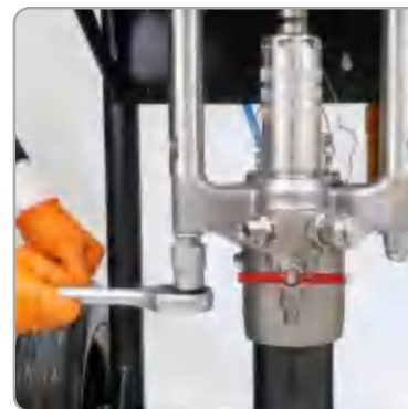
使用扳手，从拉杆上拆下泵。
