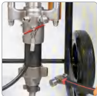
使用锤子松开流体吸液软管。
