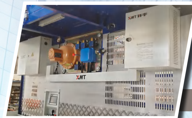
VFC box inside the cage 笼内电控箱
