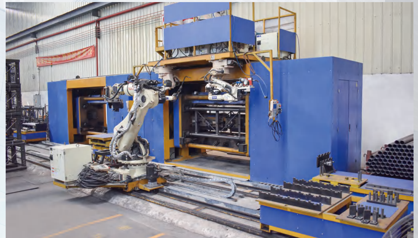
标准节全自动焊接机器人 Automatic welding robot for mast section processing
