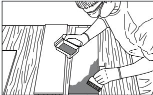
胶板表面涂刷 QMH® Cold-bonding Glue 冷粘胶水
