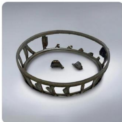
角接触轴承的保持架。 高强度黄铜车制保持架兜孔折断。 Cage for angular contact bearings. High strength brass cage pocket hole broken.
