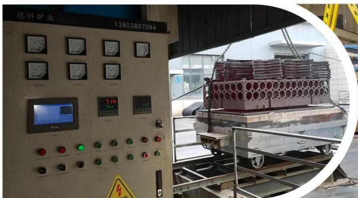
■ PLC程式加热炉
