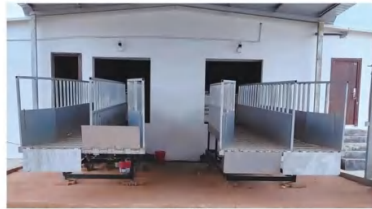
卸猪台 Pig Unloading Ramp
