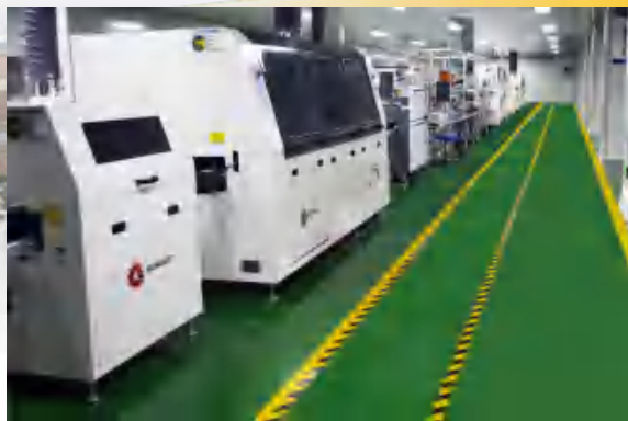
波峰焊接、自动测试、自动涂覆生产线
