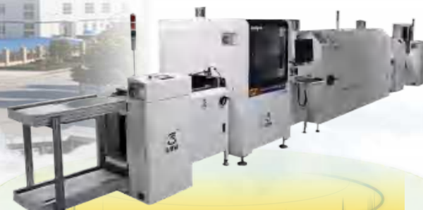
PCB涂覆自动生产线
