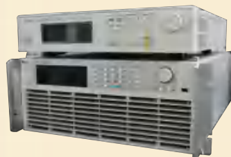
600V直流电源+ 直流电子负载
