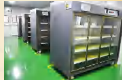
电子产品在线老化试验箱
