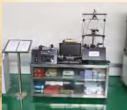
车镜反射率、失真率、 曲率测试仪
