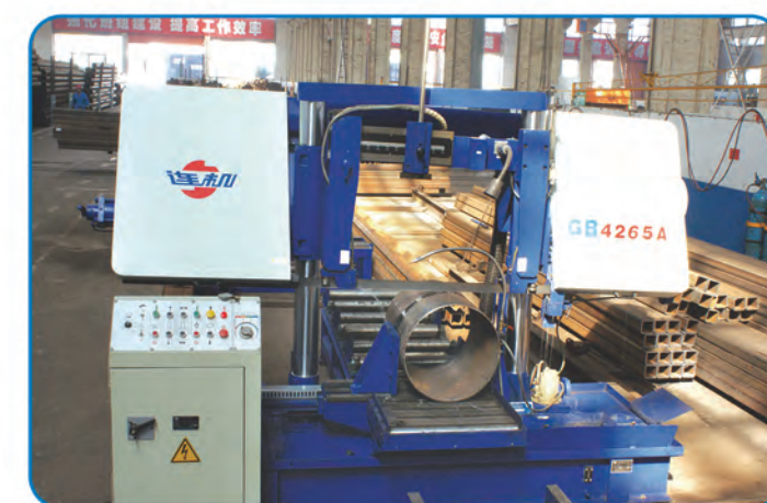
▲ 型材、异形材、管材、棒材类先进下料工艺之多角度锯切
