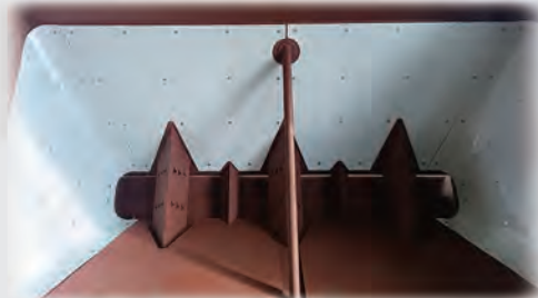
砂称量斗配置高分子防粘衬板
