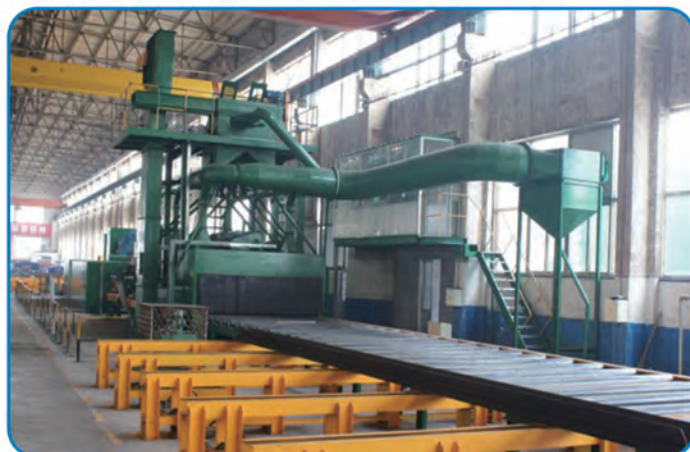
▲ 原材料使用前进行抛丸预处理
