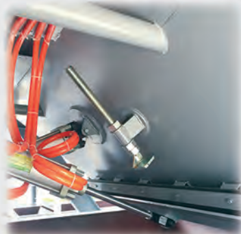
增加开度调节装置，调节不同物料卸料速度
