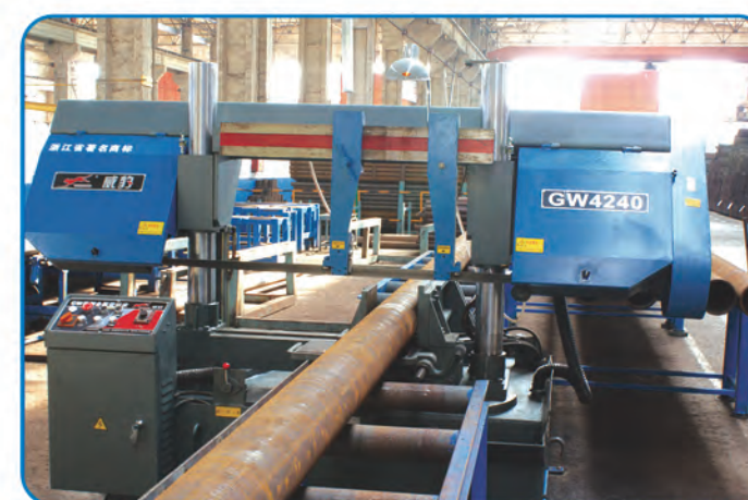
▲ 型材、异形材、管材、棒材类先进下料工艺之多角度锯切
