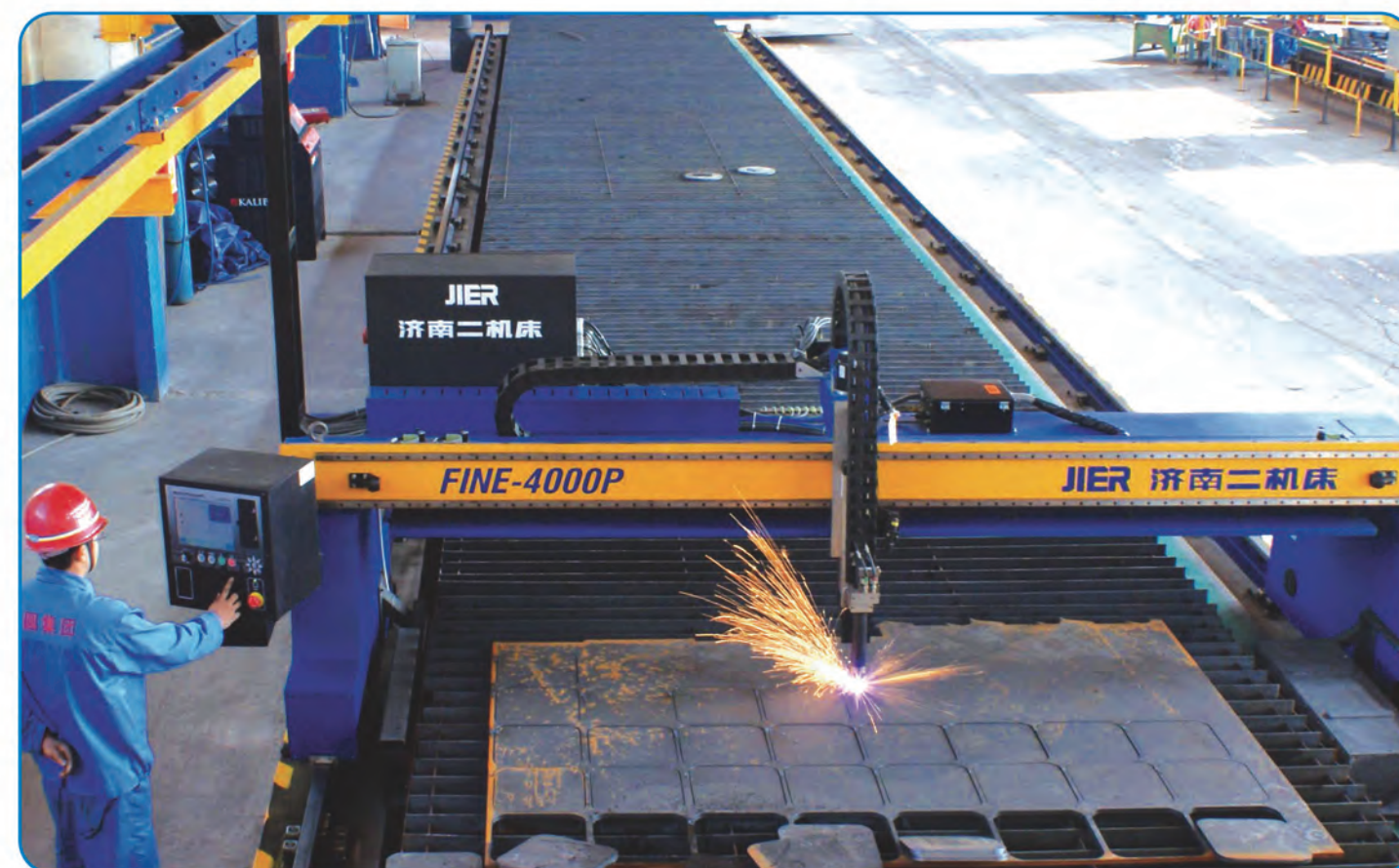
▲ 板材类先进下料工艺之数控精细等离子高速切割
