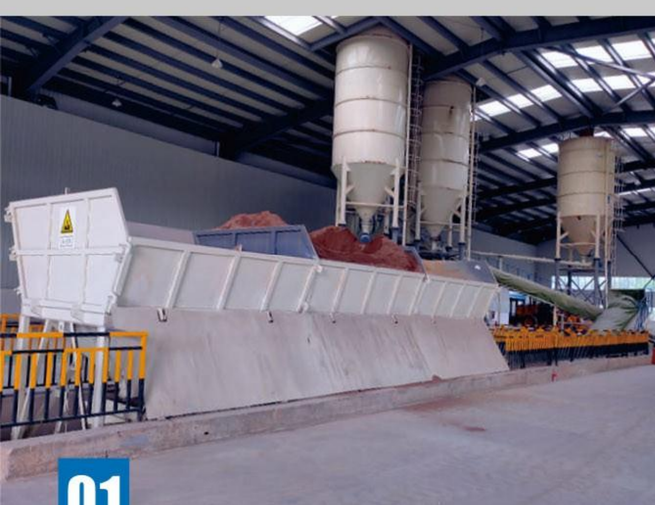
01 物料配料系统 Materials batching system
