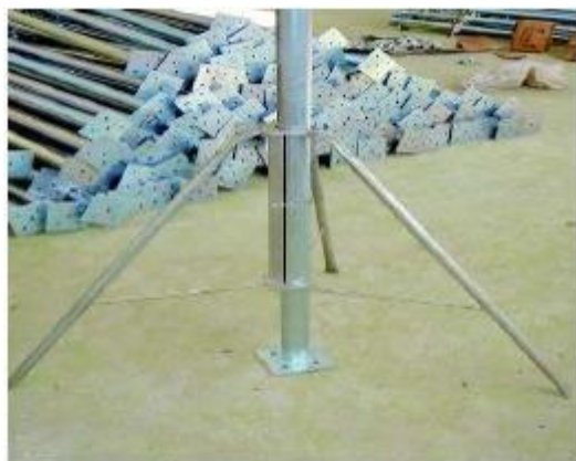
钢支撑和三角架的配合使用 combination of steel prop and tripod
