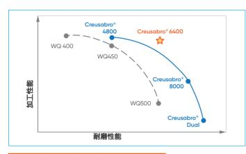
Creusabro®6400的开发是为了获得比传统的450/500 HB马氏体钢板更高的耐磨性,同时又不会降低钢板的韧性、折弯性能和机加工性能。
