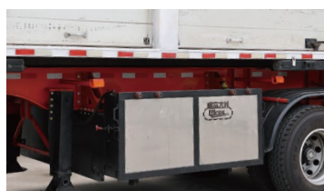
随车收藏箱可安装于货车底部
