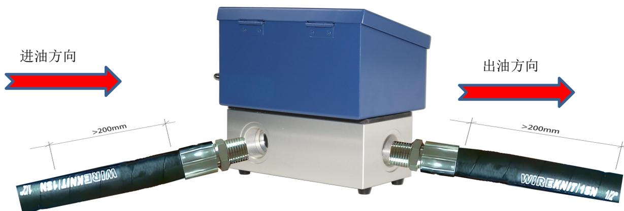
1.2 在开机检测前，检查设备的油箱油位是否足够，泵、阀、损坏部位的连接是否紧密，外部液压油是否泄漏等。检查各连接接头都已经拧紧，回路连接正确；
