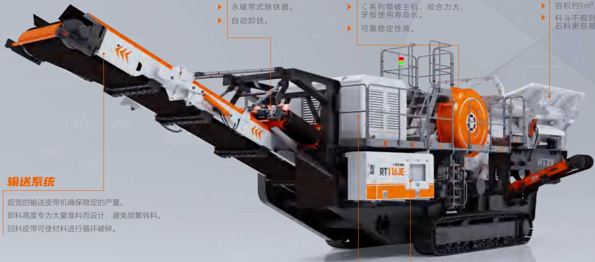
润天智科履带移动颚式破碎站结构紧凑，具有大破碎比，工作稳定性好，维护保养成本低。主机具有优良的啮合角和大冲程，为硬岩克星，宽大的进料口确保设备具有较大的产能；底盘的高度使得设备对复杂地形有良好的适应性。设备操作简单，且运输转场方便；可用于沙石骨料的生产和环保破碎。
