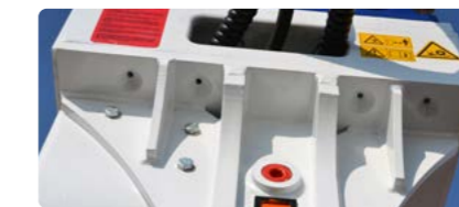
Water jets for dust suppression (optional).
