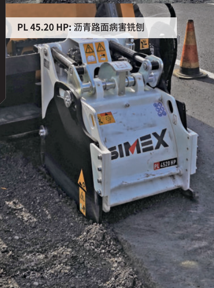
PL 45.20: 可铣刨出台阶效果和完美的坑槽轮廓
