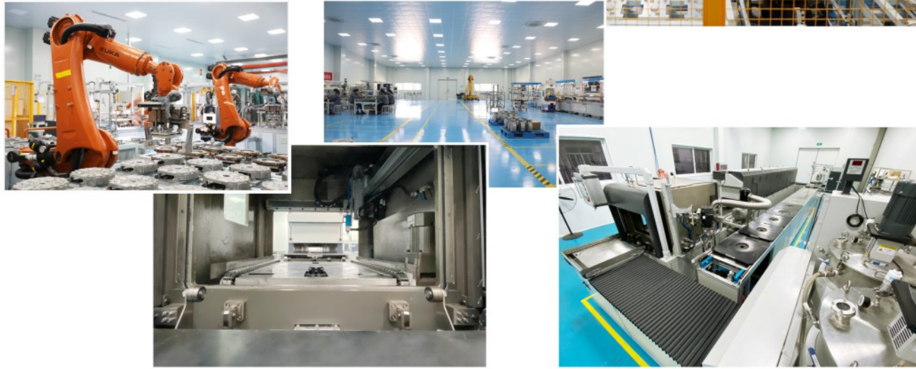
国内首条全自动轴向磁通电机装配检测生产线。
