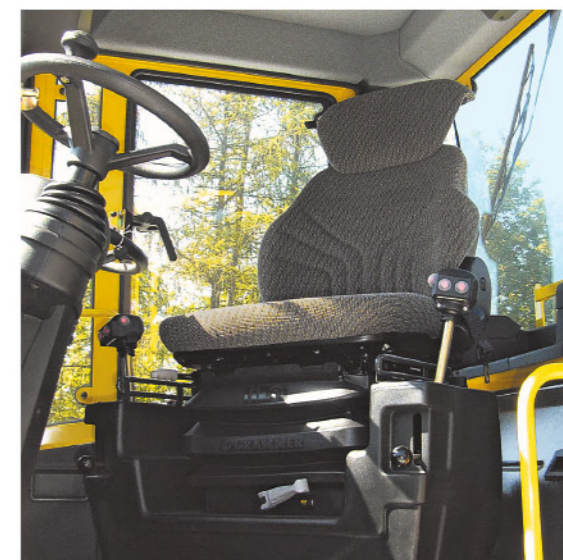
所有控制部件都易于接触:豪华型可调整座椅,配两个行走操作杆
