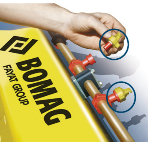
洒水杆上均匀分布8个喷水嘴，保证钢轮表面得到充分的喷淋
