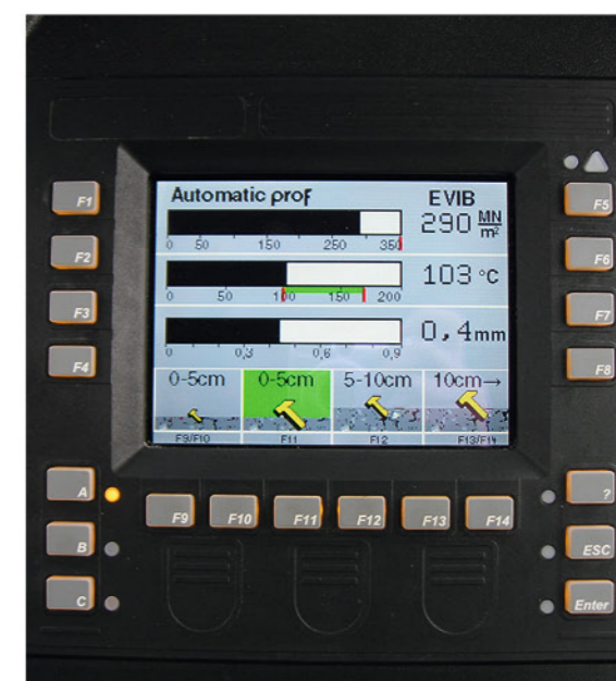
沥青压实专家系统(AM2)的控制面板
