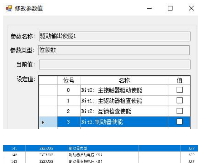
图 4.5.1 电磁制动器设置
