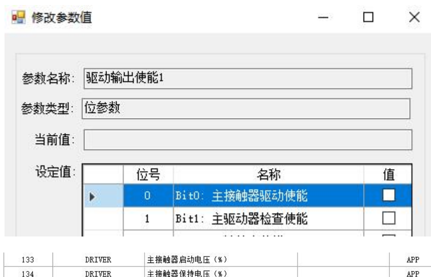
图 4.4.1 主接触器设置
