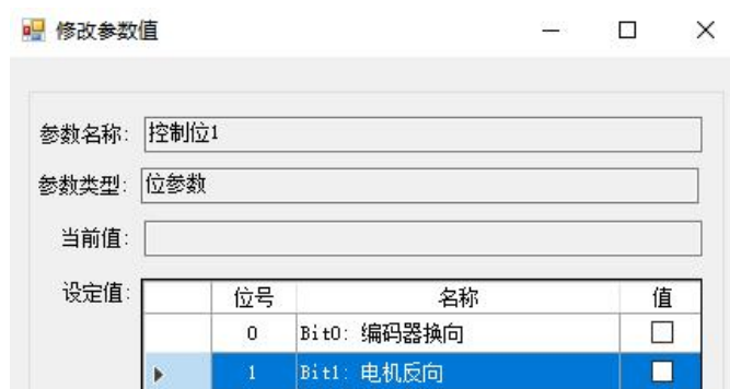
图 4.3.1 电机方向设置
