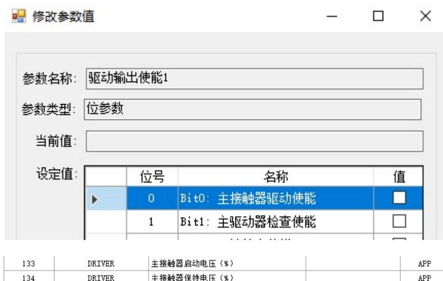
图 4.4.1 主接触器设置
