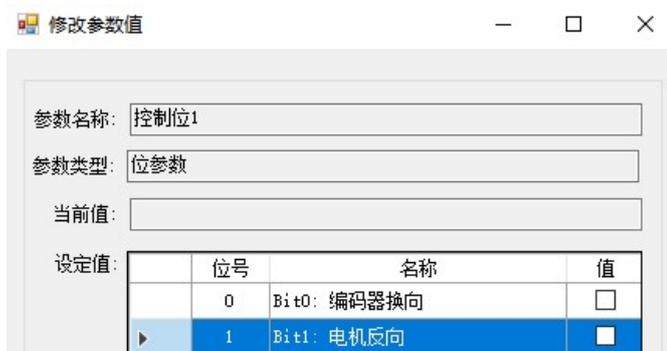
图 4.3.1 电机方向设置
