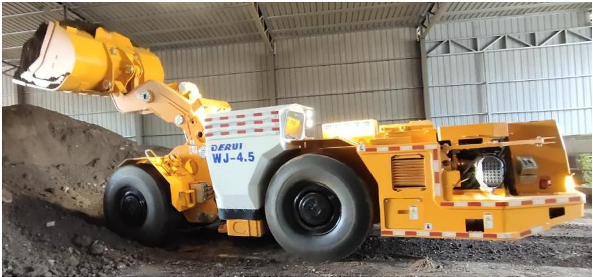
WJ-4.5 地下铲运机适用于4.3\*4.3m矿井巷道，具有很高的智能化程度，使用安全可靠，整机稳定性好，能大幅度提高矿山生产率和盈利能力。
