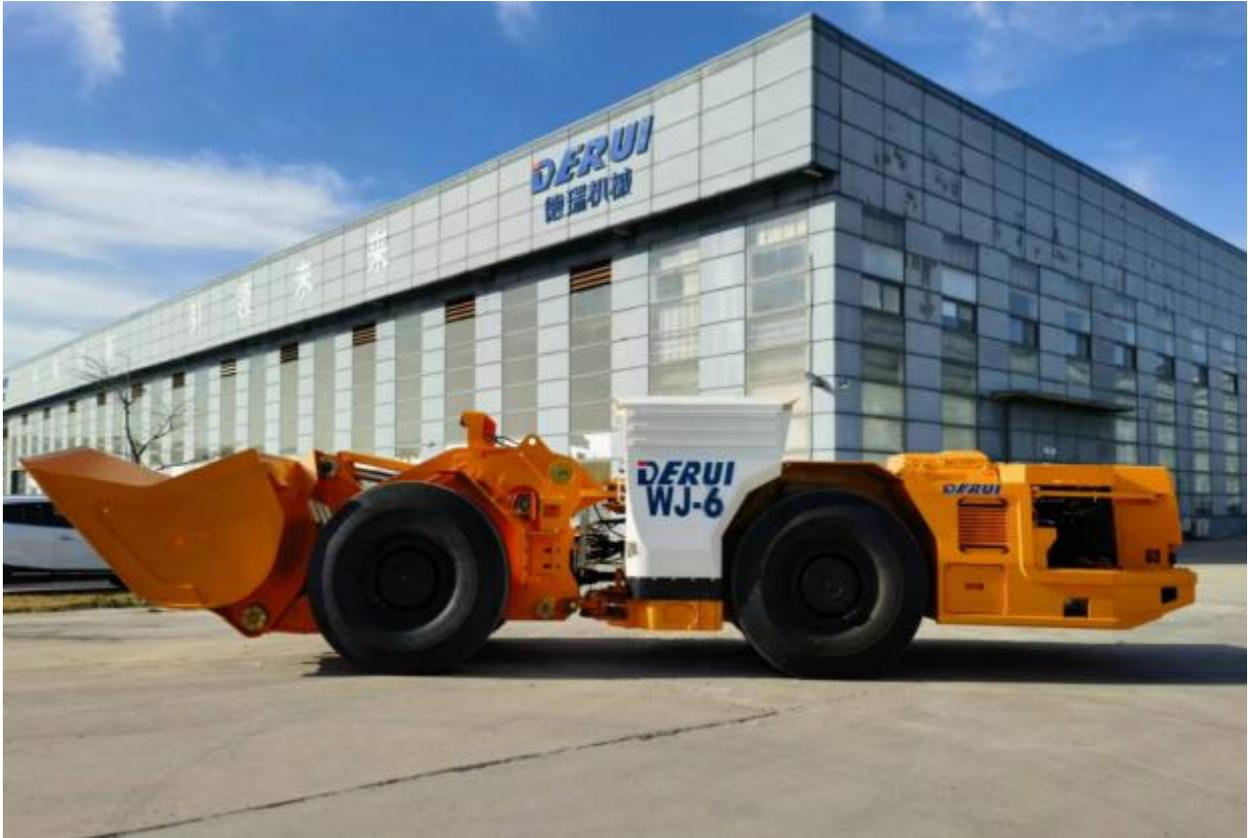
DRWJ-6地下铲运机适用于4.6\*4.6m矿井巷道，具有智能化程度高、使用安全可靠、整机稳定性好等产品优势，能大幅度提高矿山生产率和盈利能力。
