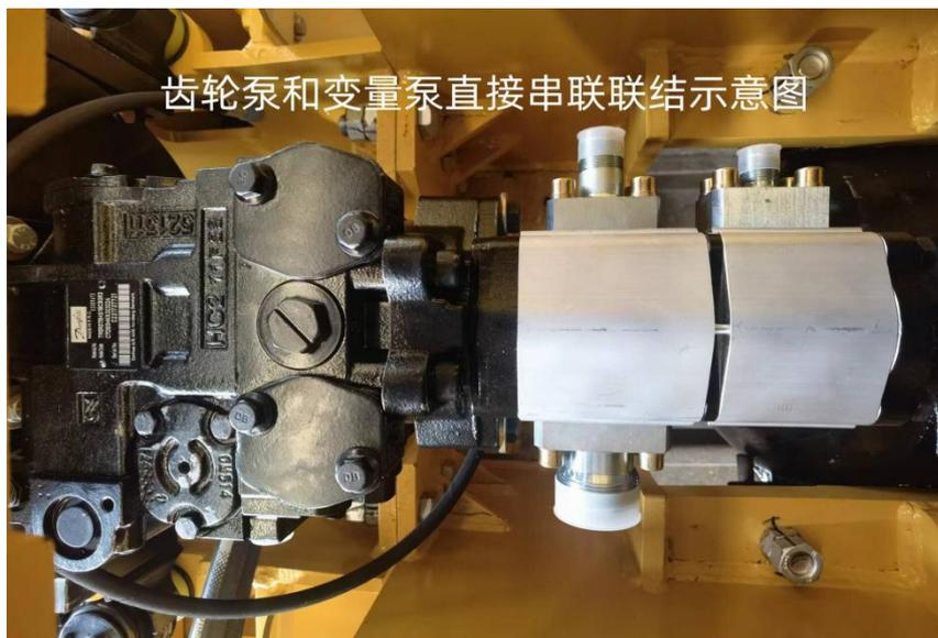
采用这种结构，取消了皮带轮减少了维护作业也避免了皮带经常松弛带来的故障，动力输出也得到提升。实践证明，齿轮泵的使用寿命也得到了很大的提高。
