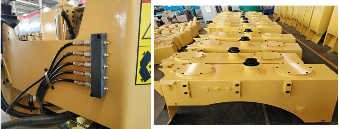
5.9 液压油管、接头对丝全部采用进口知名品牌，马牌或固特异等厂家，使用寿命大大延长，避免了跑、冒、滴、漏和爆管现象的发生。
