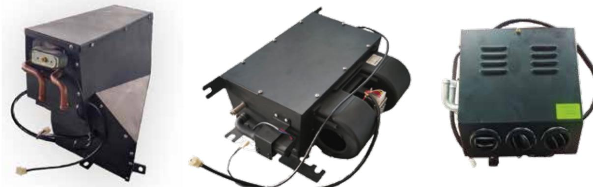
上述实例为蒸发器模块。它可以根据客户要求开发定制, 能够实现单制冷功能、冷暖一体式, 或者只有暖气功能。还可以根据客户需求开发定制, 结合工作环境特点, 您可以选择蒸发器的换热器芯体类型, 例如铝合金材质的平行流式或者铜管穿管式。其尺寸大小以及出风方式均可以按照客户需求制作。
