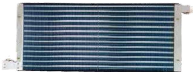
此实例呈现了一个适用于诸如谷物收割机等农业机械的制冷空调模块, 尤其适用于小麦收割机驾驶舱、玉米收割机驾驶舱以及青贮饲料机车厢等场景。它采用了具有防堵塞设计和防尘特性的冷凝器。电压为直流 12V/24V。它配备了机械驱动的往复式压缩机, 制冷量在 5 至 6 千瓦之间。制冷剂采用R134A环境友好型制冷剂。
