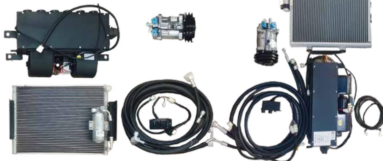
下面实例是两款适用于农业机械的拖拉机冷暖空调模块, 冷凝器不易堵塞设计, 防尘, 电压: 直流12V/24V; 机械驱动型往复式压缩机, 制冷量3-4KW, 制热量4-5KW。
