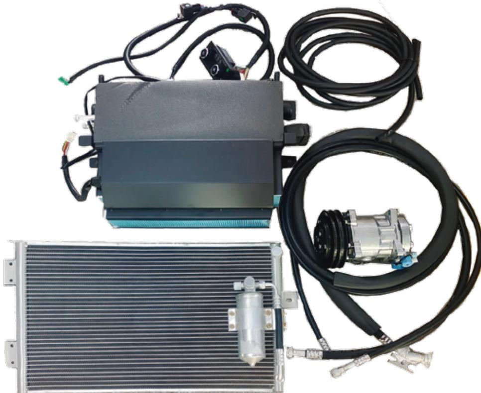
实例为一款适用于农业机械的拖拉机冷暖空调模块，冷凝器不易堵塞设计，防尘，电压：直流12V/24V；机械驱动型往复压缩机，制冷量3-4KW，制热量4-5KW。
