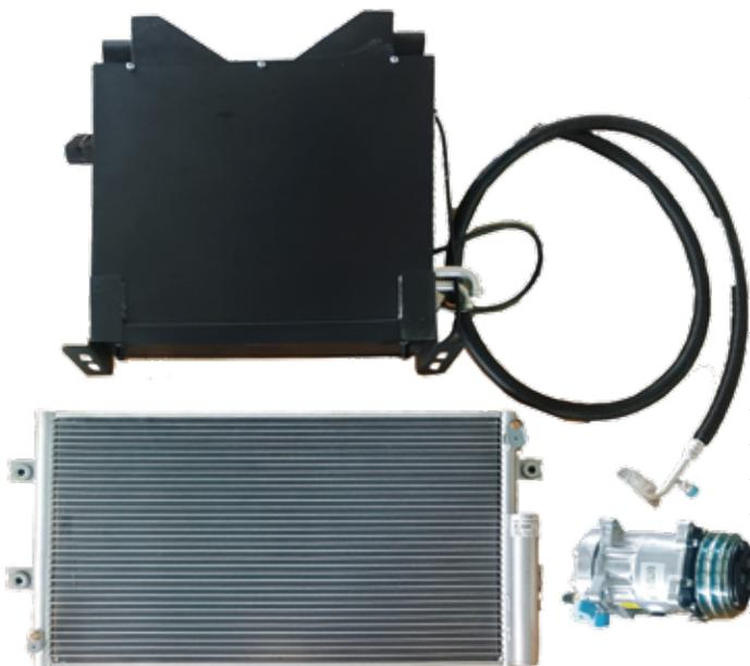
这个实例代表了一款适用于工程机械的冷暖空调模块，尤其是在诸如挖掘机驾驶舱、起重机驾驶舱和装载机车厢等场景中。它采用了具有防堵塞设计和防尘特性的冷凝器。电压为直流12V/24V。它配备了机械驱动的往复压缩机，制冷量在3-4 KW之间，制热量在4-5 KW之间。
