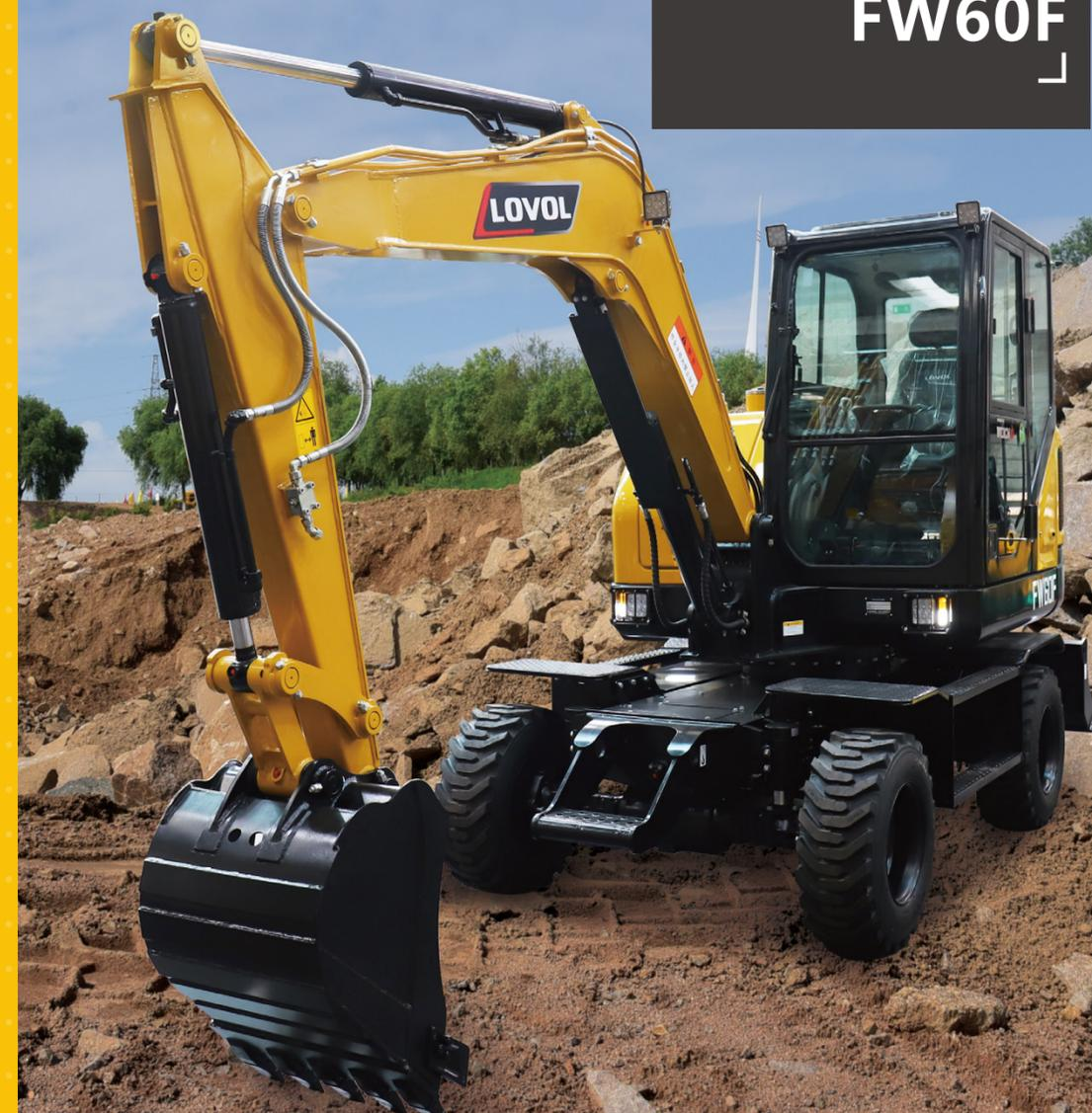
整机重量: 5700kg 铲斗容量: 0.23m<sup>3</sup> 发动机额定功率: 53.7kW/2100rpm
