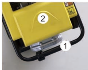
1. 骨轮帮助短途搬运。 2. 塑料盖板起到美观、保护发动机作用。
