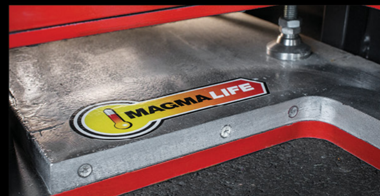
最完美的保护：加热条铸造进一整块铝板中
