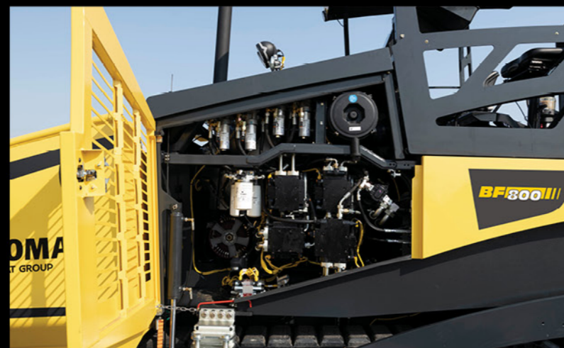
开启度大的维修舱门，便于接触所有保养部件
