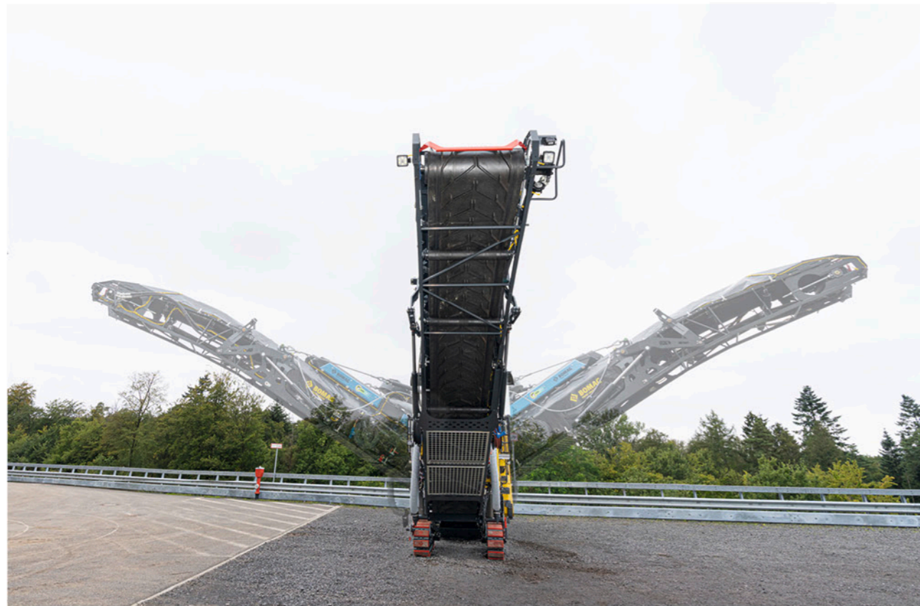
卸料皮带130°回转角度确保了装料时最大的机动性和灵活性。
