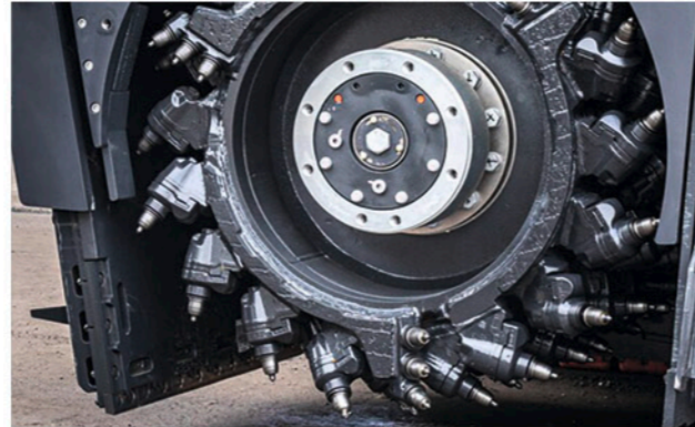
铣刨鼓仓和铣刨鼓的硬质合金耐磨边板是可以更换的。
