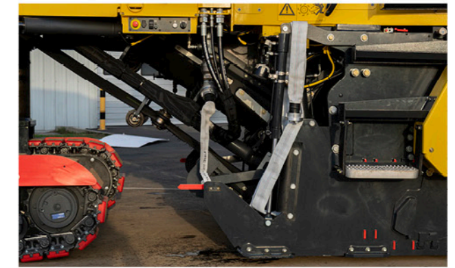
集料皮带也有最佳的密封性, 可靠性高, 减少粉尘污染。
