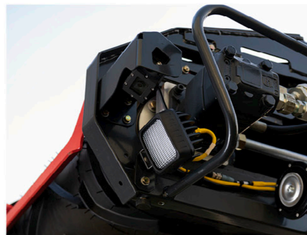
高级夜间照明套包还包括卸料皮带照明灯, 皮带的工作情况清晰可见。
