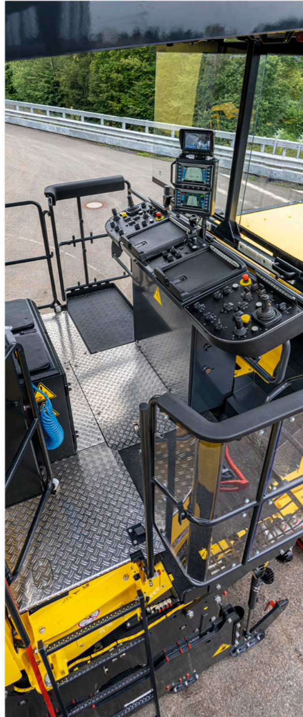
专门设计的操作台和可旋转的控制面板，保证驾驶员的清晰视野，操作更直观。
