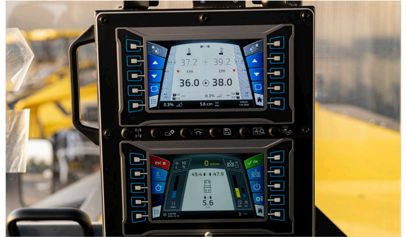
宝马格轻松找平系统：能轻松选择两侧边板的传感器、横坡传感器、前传感器或多个传感器可以选配。操作直观，工作起来轻松无压力。
