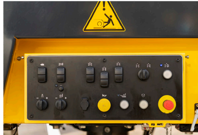
地面操作控制台和辅助显示器，方便地面操作人员控制机器。
