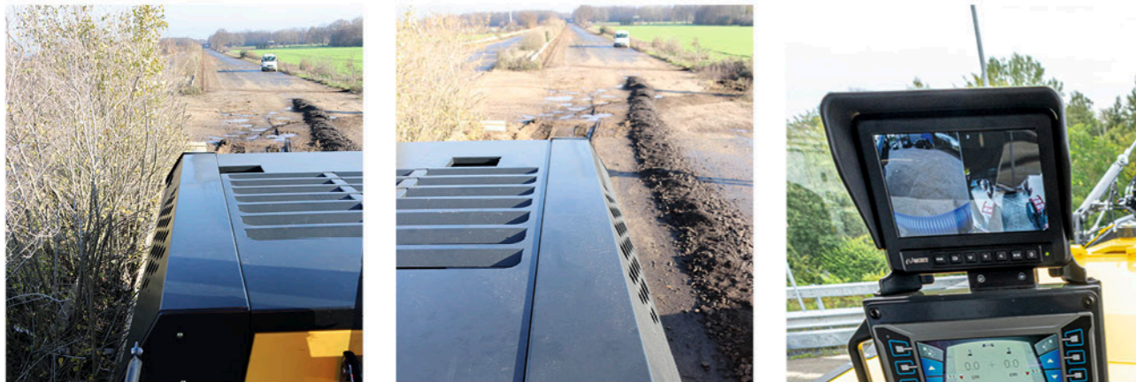
机身尾部区域也很整洁，布局清晰，摄像头系统覆盖了这里的最后一个盲点。工作更安全。
