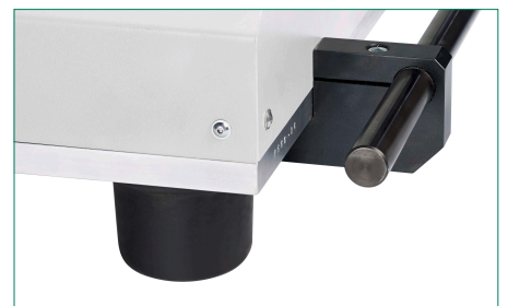
机器侧面搬运把手和橡胶底脚
