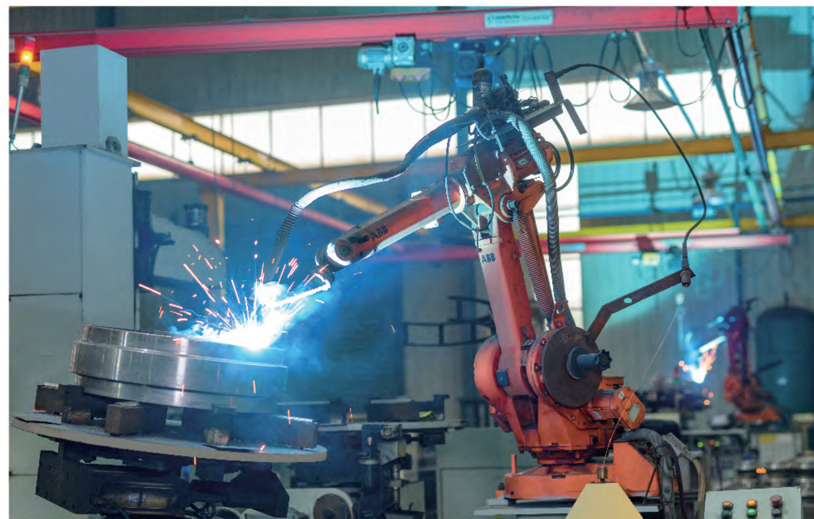
Robot welding 机器人焊接
