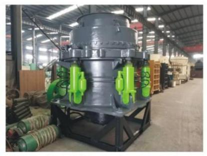
多缸液压圆锥破碎机广泛应用于金属与非金属矿、水泥厂,砂石冶金等行业。适用中细碎普氏硬度≤5~16 的各种矿石和岩石,如铁矿石、有色金属矿石、花岗岩、石灰岩、石英岩、沙岩、鹅卵石等。
