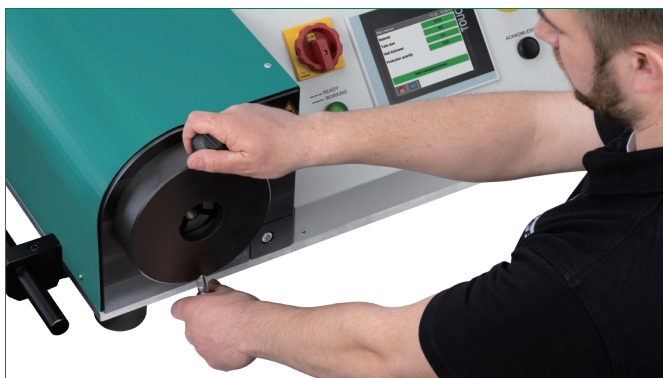
关闭成型舱门顺势向前推入底部，然后顺时针旋转至锁紧。
