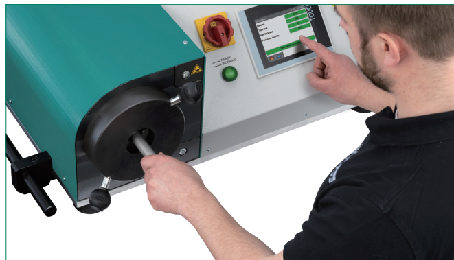
将管端仔细地伸入模具，直至确保插入成型端头底部。
