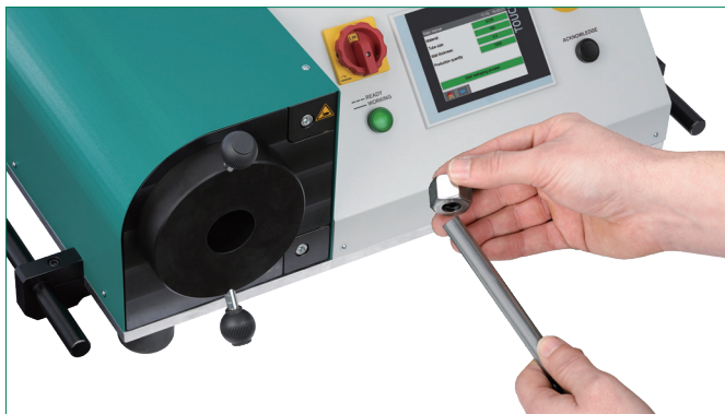
将卡套螺母套进管端，并注意卡套螺母的方向。
