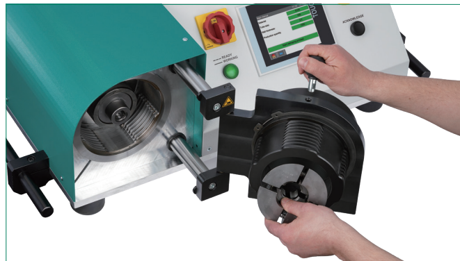
将成型夹具嵌入机器的开放式成型舱门，完全推入直至停止。
