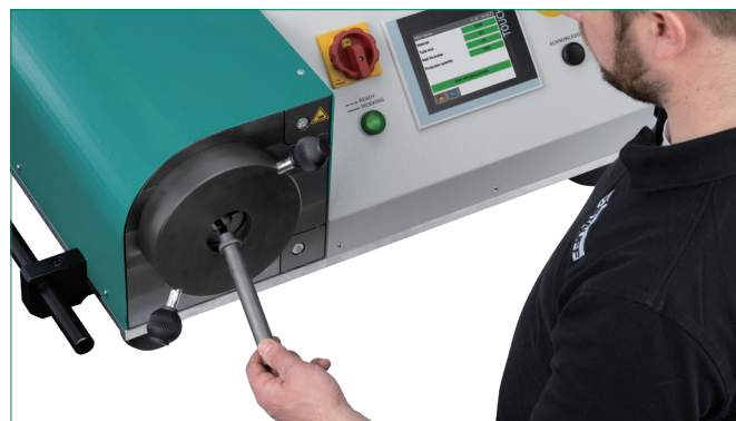
移出管子，目视检查成型形状。
