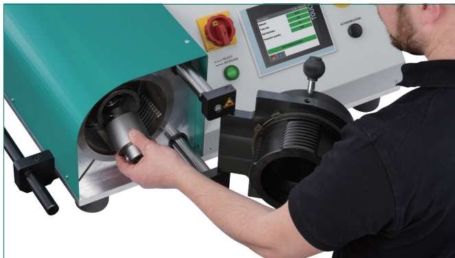
插入成型端头至底座卡槽，并用自身卡口销固定。
