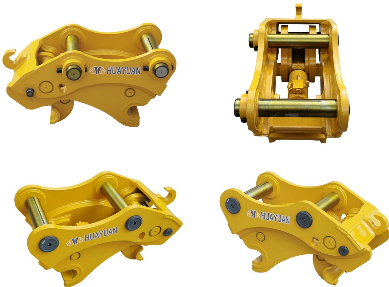
快速连接器，也称为快速接头、快换装置、快接装置，是常用的挖掘机配件，适配各种型号挖掘机，用于辅助快换作业，可在短时间内快速、轻松地更换挖斗和抓具、松土器、破碎锤、液压剪等不同属具。
