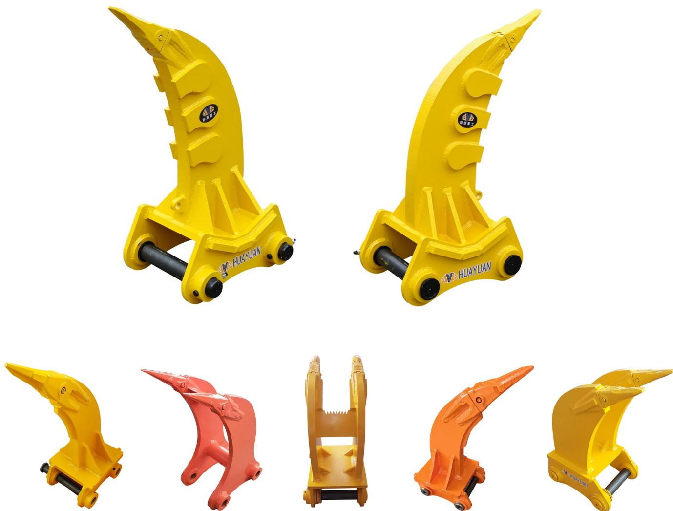
松土器，配套挖掘机使用，具有破碎和翻松功能，用于开挖有裂纹的岩石、挖掘树根，破碎冻土，也可开挖沥青路面，适用于硬土、次坚石、风化石及其他顽固物体的破碎、分裂，以便于用挖斗进行挖掘及装载作业。可根据需求设计为单钩或双钩。
