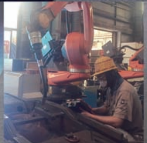
iCAT W600焊枪 在某重工企业工程机械焊装车间
