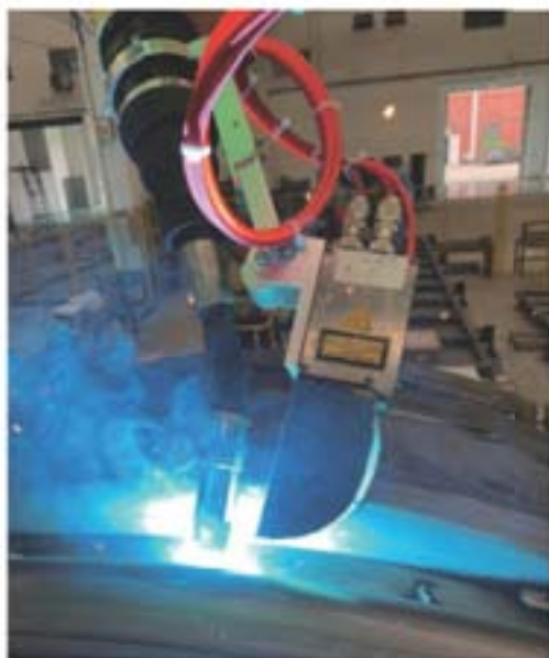
激光跟踪器与iCATmini W600焊枪组合应用 在某重大工焊装车间
