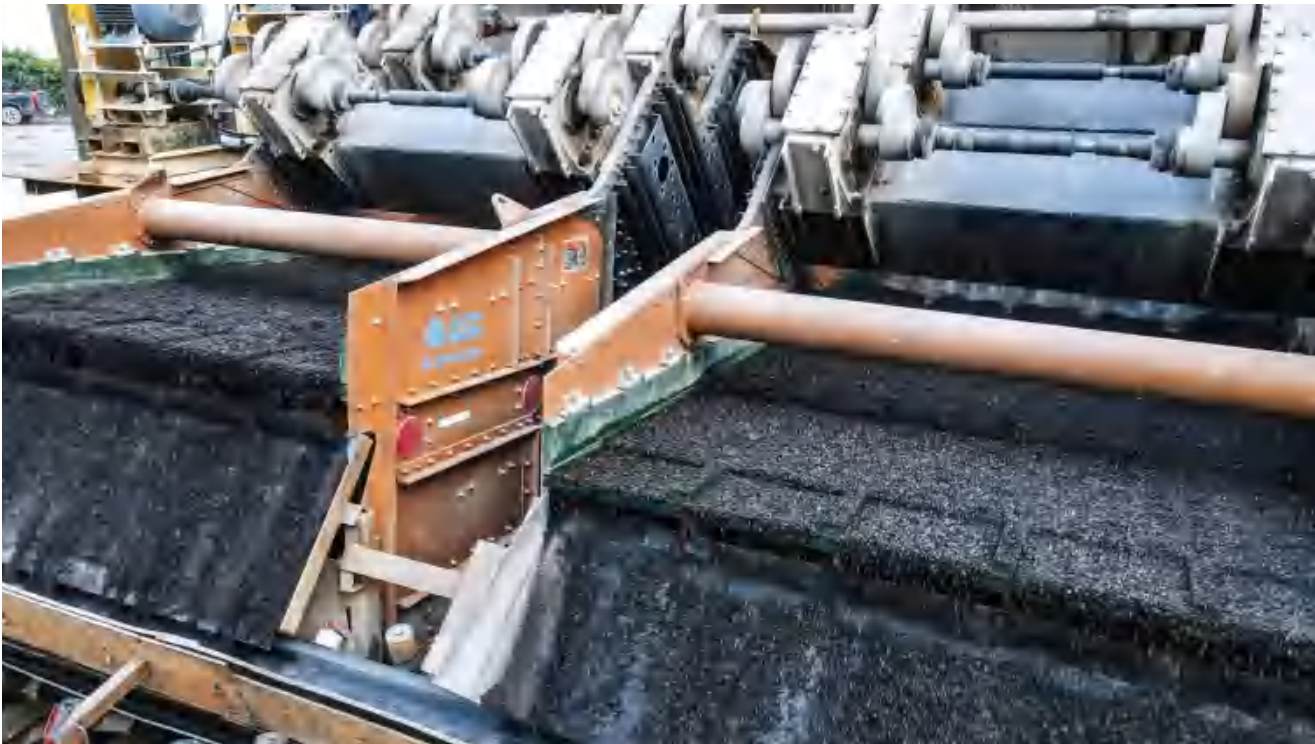
SLW3097型大型高频脱水筛是我公司自主研发的新型高效脱水振动筛。它能使效率提升30%，细砂流失减少13%运行稳定处理量大等优点。
