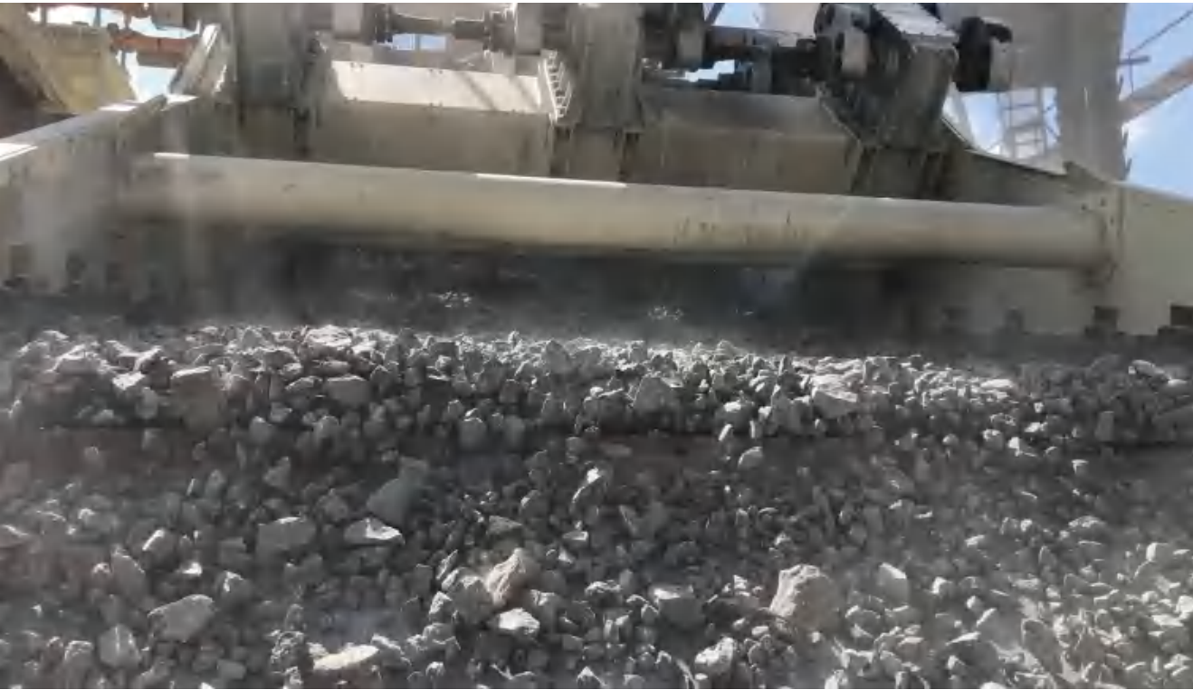
现场考察重点，3000吨/小时处理能力，观察筛面的筛分效率，翻料堰的作用，以及隔震架启停机对基础的影响 备注：该项目客户没有防尘要求，设备已经预留除尘防尘接口位置
