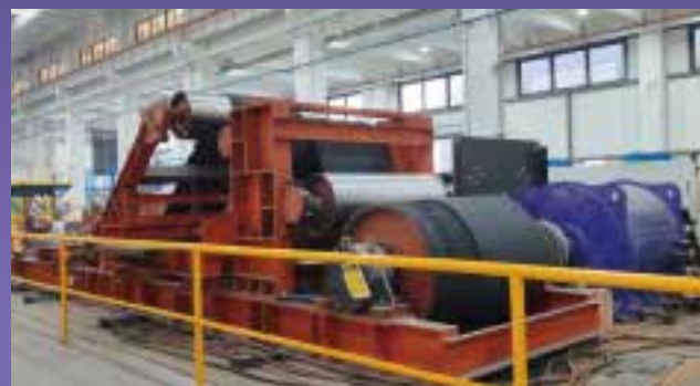
全球首个 20M W 永磁电动滚筒试验站，20000k W 测试台
