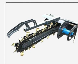
开沟机 Ditching machine
